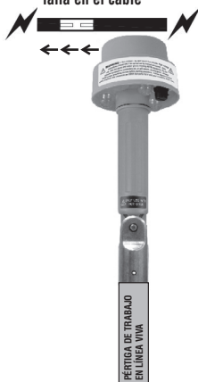
Fig. 2: Búsqueda de una falla en el cable
