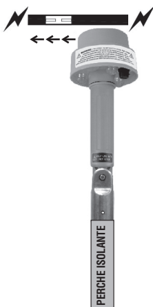
Fig. 2 : Identification d'une déféctuosité dans un câble
